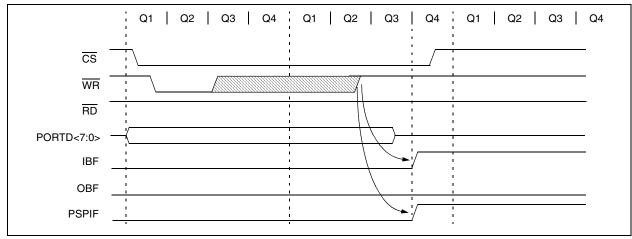
FIGURE 10-4: PARALLEL SLAVE PORT READ WAVEFORMS
