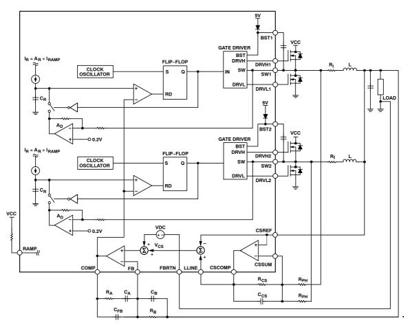
Figure 27. Dual-Phase PWM Mode Operation
