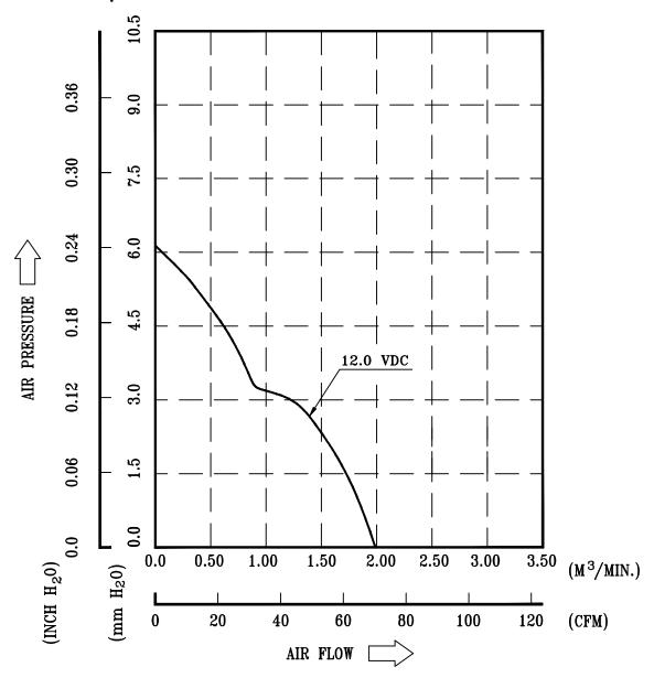
\* TEST CONDITION: INPUT VOLTAGE — OPERATION VOLTAGE TEMPERATURE HUMIDITY — ROOM TEMPERATURE 65%RH
