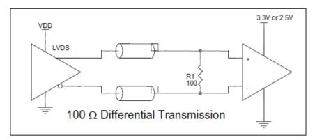
FIGURE 4. TYPICAL LVDS DRIVER TERMINATION
