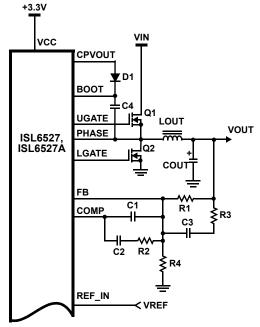
FIGURE 2. OUTPUT VOLTAGE SELECTION
