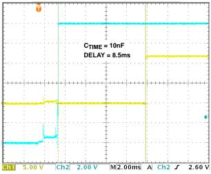
FIGURE 10. V<sub>IN</sub>/SEQ\_EN VALID TO ENABLE\_A
