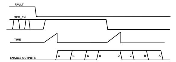
FIGURE 2. ISL8702A OPERATIONAL DIAGRAM
