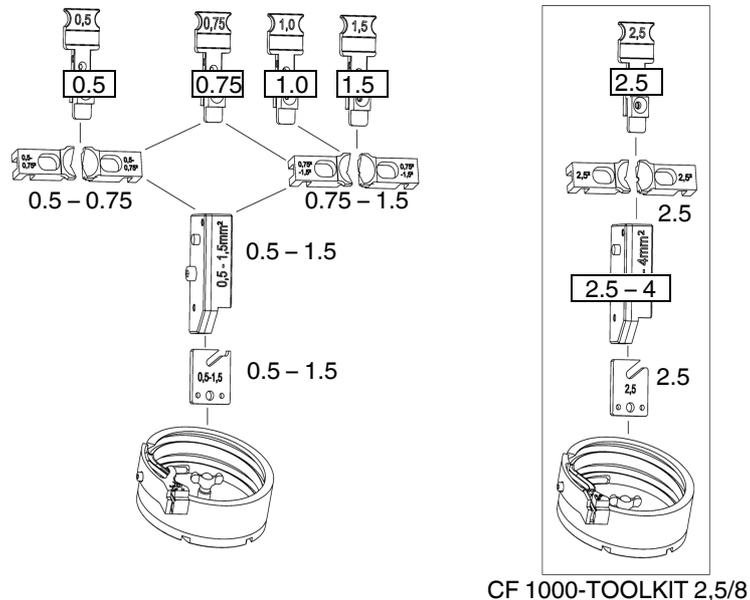
Figure 3-1 Example of CF 1000-1,5 (value in mm<sup>2</sup>)
