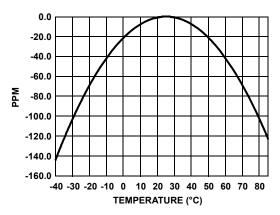
FIGURE 20. RTC CRYSTAL TEMPERATURE DRIFT
