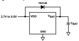
FIGURE 23. SUPERCAPACITOR CHARGING CIRCUIT
