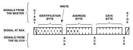
FIGURE 16. BYTE WRITE SEQUENCE
