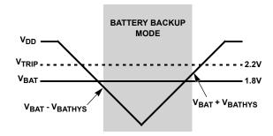
FIGURE 11. BATTERY SWITCHOVER WHEN  $V_{BAT} < V_{TRIP}$
