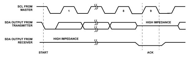
FIGURE 15. ACKNOWLEDGE RESPONSE FROM RECEIVER
