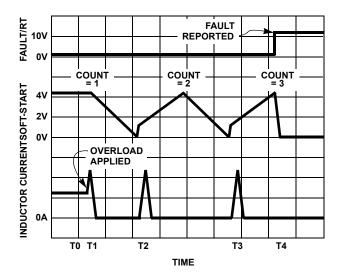
FIGURE 8. OVER-CURRENT OPERATION
