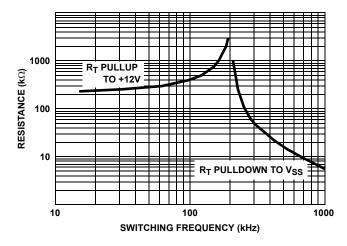
FIGURE 4. R<sub>T</sub> RESISTANCE vs FREQUENCY
