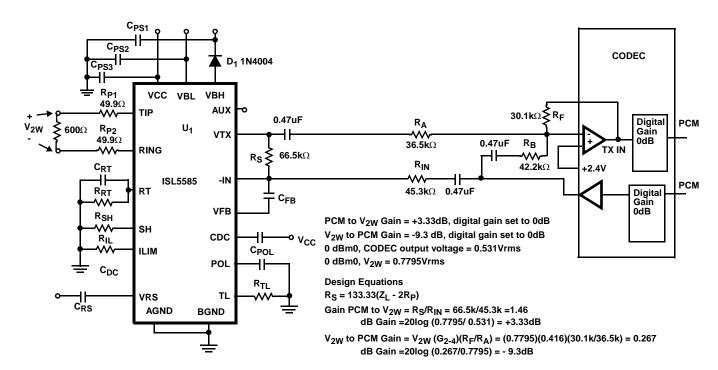
FIGURE 17. ISL5585 3.3V APPLICATION CIRCUIT
