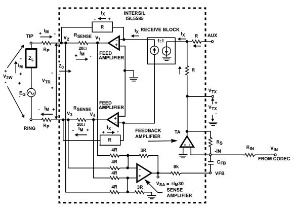
FIGURE 4. AC SIGNAL TRANSMISSION MODEL
