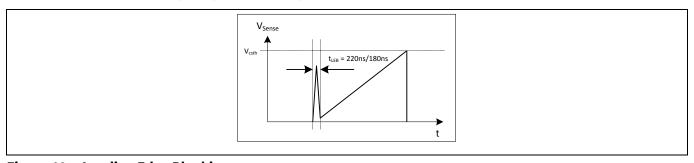
Figure 19 Leading Edge Blanking
