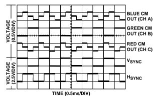
FIGURE 27. H AND V SYNCS ENCODED
