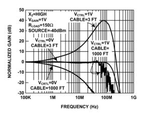
FIGURE 5. GAIN VS FREQUENCY FOR VARIOUS V<sub>CTRL</sub> AND CABLE LENGTHS
