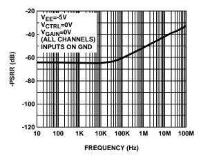
FIGURE 14. (-)PSRR vs FREQUENCY
