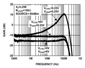
FIGURE 4. GAIN vs FREQUENCY FOR VARIOUS V<sub>CTRL</sub> AND V<sub>GAIN</sub>
