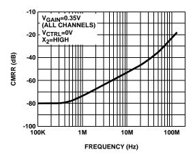
FIGURE 11. COMMON-MODE REJECTION
