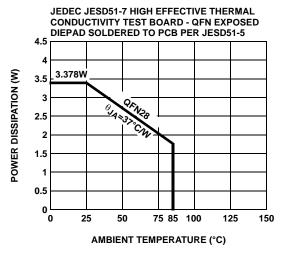
FIGURE 25. PACKAGE POWER DISSIPATION vs AMBIENT TEMPERATURE
