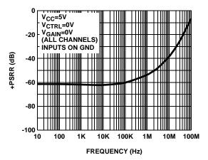
FIGURE 13. (+)PSRR vs FREQUENCY
