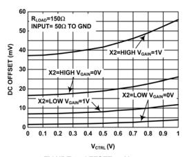
FIGURE 9. OFFSET vs V<sub>CTRL</sub>
