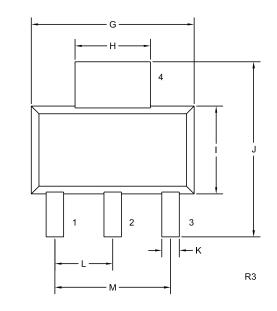
LEAD CODE: 1) Cathode 2) Anode 3) Gate
