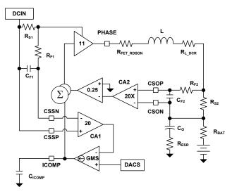
FIGURE 29. ADAPTER CURRENT LIMIT LOOP
