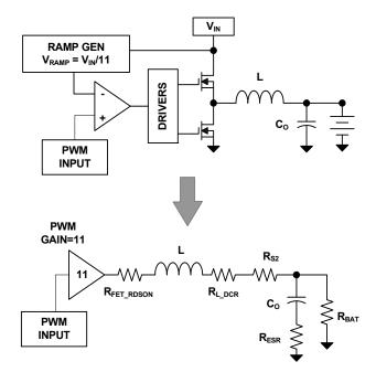
FIGURE 26. SMALL SIGNAL AC MODEL
