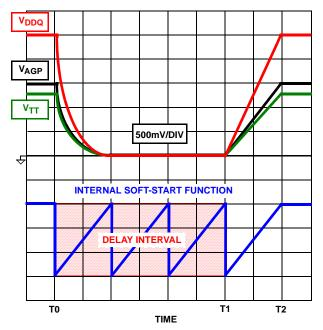
FIGURE 3. V<sub>DDQ</sub> OVERCURRENT PROTECTION AND V<sub>TT</sub>/V<sub>AGP</sub> LDO UNDER VOLTAGE PROTECTION RESPONSES
