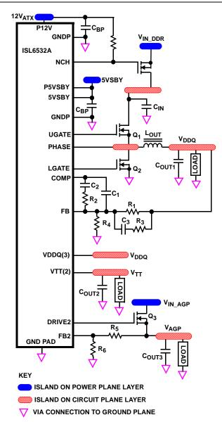
FIGURE 4. PRINTED CIRCUIT BOARD POWER PLANES
