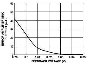
FIGURE 18. LINEAR CONTROLLER GAIN
