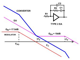
FIGURE 17. FEEDBACK LOOP COMPENSATION
