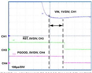
FIGURE 10. VIN FALLING TO PGOOD FALLING DELAY TIME
