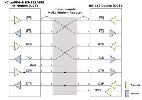
Sample Wireless Connection: DTE <--> DCE 700 DCE <--> DCE
