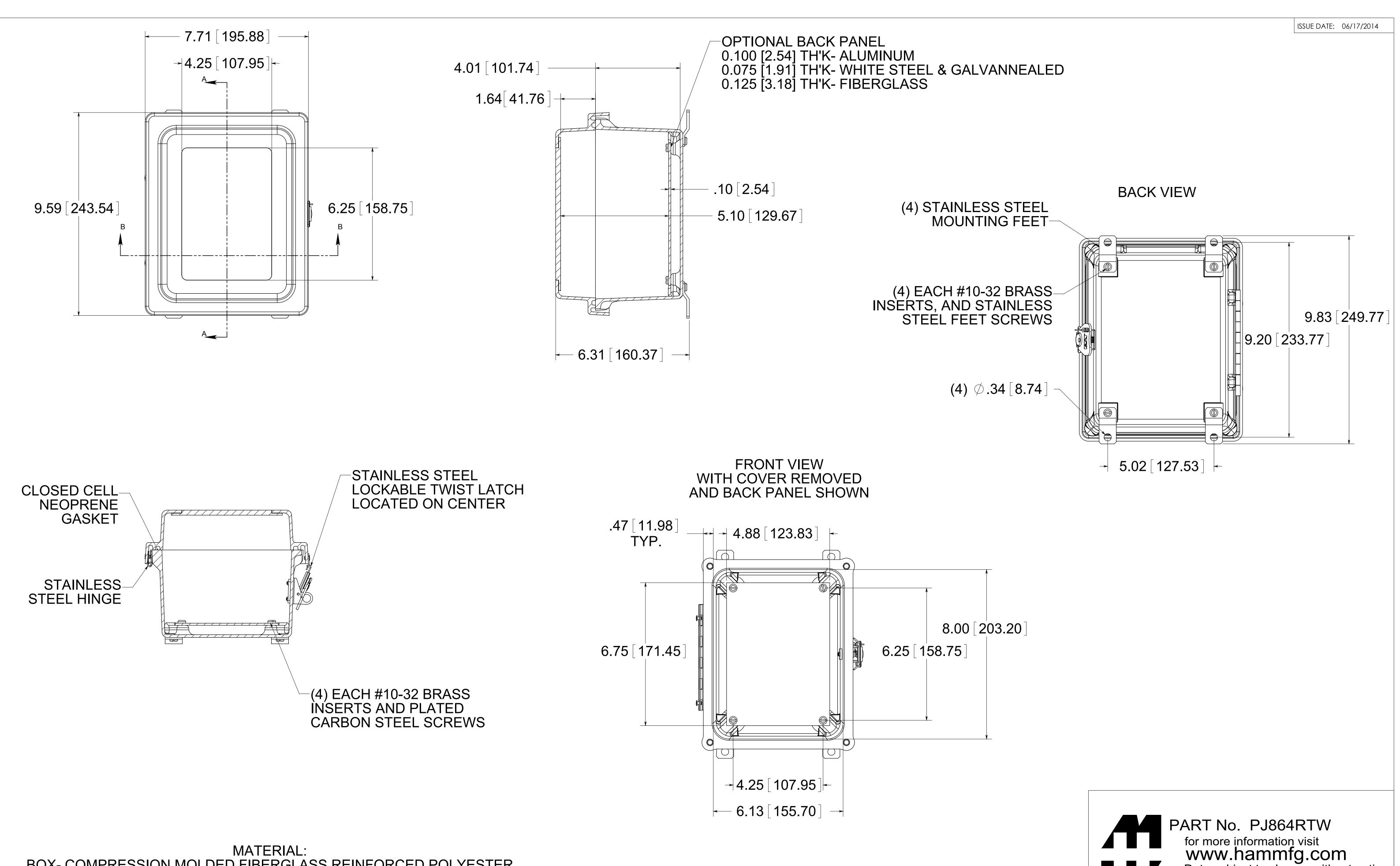
BOX- COMPRESSION MOLDED FIBERGLASS REINFORCED POLYESTER COVER- COMPRESSION MOLDED FIBERGLASS REINFORCED POLYESTER WINDOW-POLYCARBONATE
