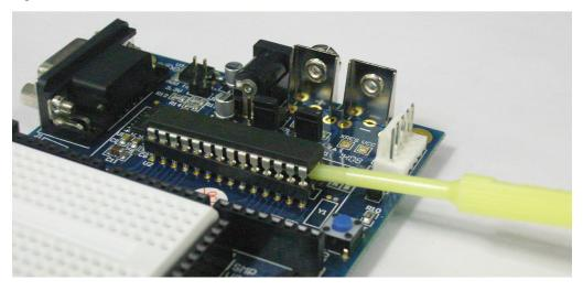
Figure A-4. Lift IC - One Side
