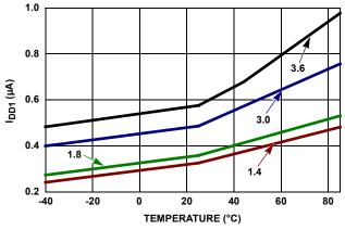
FIGURE 3. IDD1 vs TEMPERATURE
