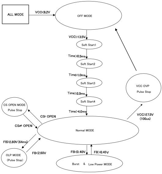
Figure 29. Sequence Diagram (LATCH)
