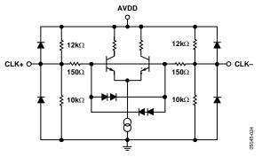
Figure 24. Clock Inputs
