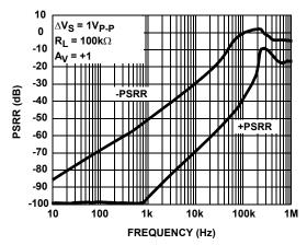
FIGURE 9. PSRR vs FREQUENCY
