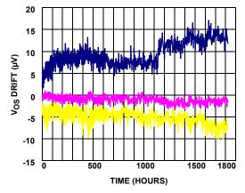
FIGURE 12. VOS DRIFT (SOT-23 PACKAGE) vs TIME
