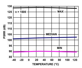
FIGURE 23. PSRR vs TEMPERATURE ±1.5V TO ±2.5V
