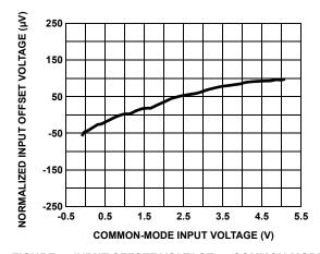
FIGURE 5. INPUT OFFSET VOLTAGE vs COMMON-MODE INPUT VOLTAGE
