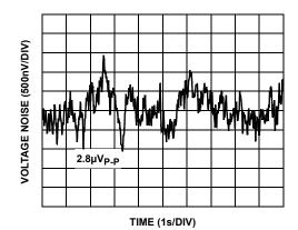
FIGURE 11. 0.1Hz TO 10Hz INPUT VOLTAGE NOISE
