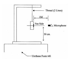
1 METER FROM MICROPHONE TO FAN INTAKE
