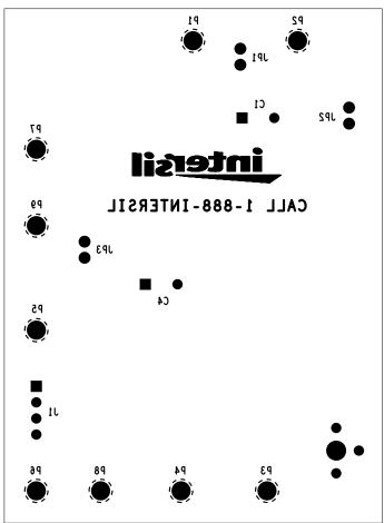
FIGURE 26. BOTTOM LAYER SOLDER SIDE
