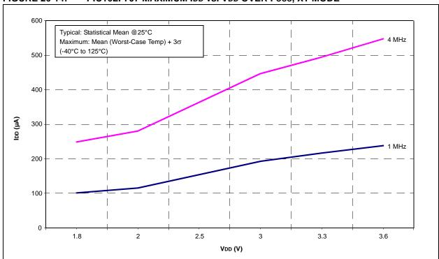
FIGURE 26-15: PIC16F707 TYPICAL IDD vs. VDD OVER FOSC, XT MODE, VCAP = 0.1 µF
