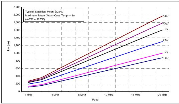
FIGURE 26-5: PIC16F707 MAXIMUM IDD vs. VDD OVER FOSC, EXTRC MODE, VCAP = 0.1µF
