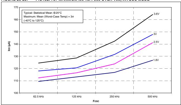
FIGURE 26-21: PIC16F707 MAXIMUM IDD vs. FOSC OVER VDD, INTOSC MODE, VCAP = 0.1µF
