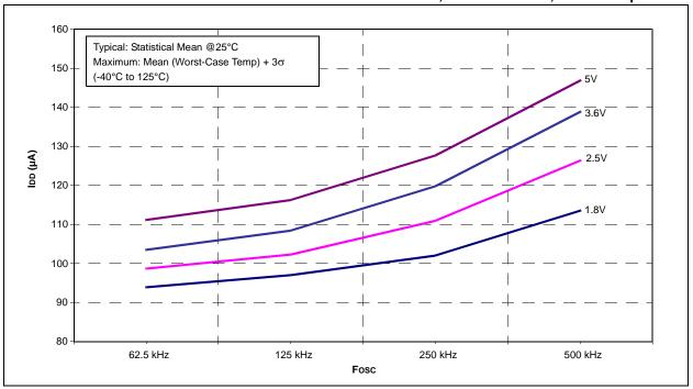
FIGURE 26-24: PIC16LF707 TYPICAL IDD vs. Fosc OVER VDD, INTOSC MODE
