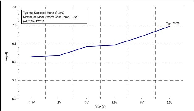
FIGURE 26-44: PIC16LF707 TYPICAL ADC IPD vs. VDD
