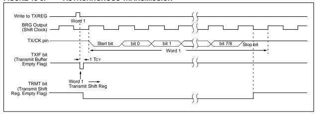
FIGURE 18-4: ASYNCHRONOUS TRANSMISSION (BACK-TO-BACK)
