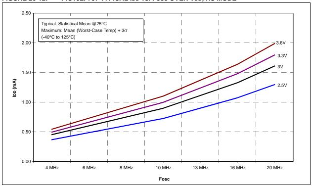
FIGURE 26-13: PIC16F707 MAXIMUM IDD vs. VDD OVER FOSC, XT MODE, VCAP = 0.1 µF
