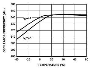
FIGURE 9. OSCILLATOR FREQUENCY vs TEMPERATURE
