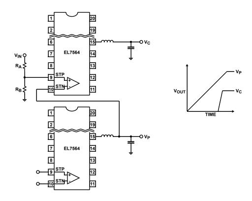
FIGURE 25. OFFSET POWER TRACKING
