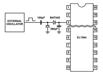
FIGURE 23. OSCILLATOR SYNCHRONIZATION
