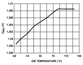
FIGURE 13. V<sub>REF</sub> vs DIE TEMPERATURE
