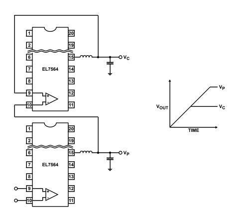
FIGURE 24. LINEAR POWER TRACKING
